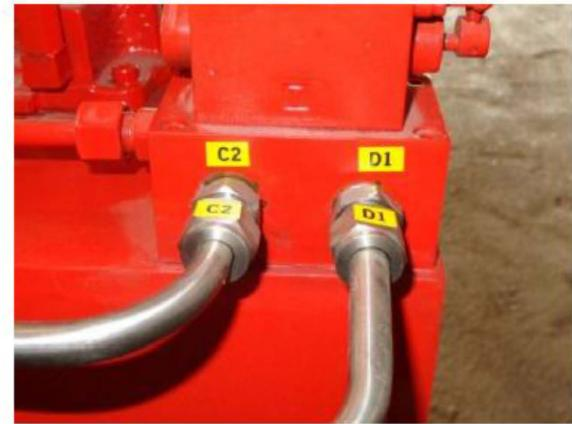
Порт С2 соединяется с передним портом гидроцилиндра, а порт D1 соединяется с задним портом гидроцилиндра.
